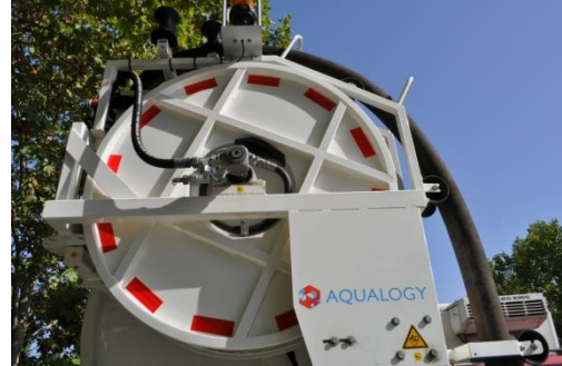
Detalle carrete manguera agua a alta presión
