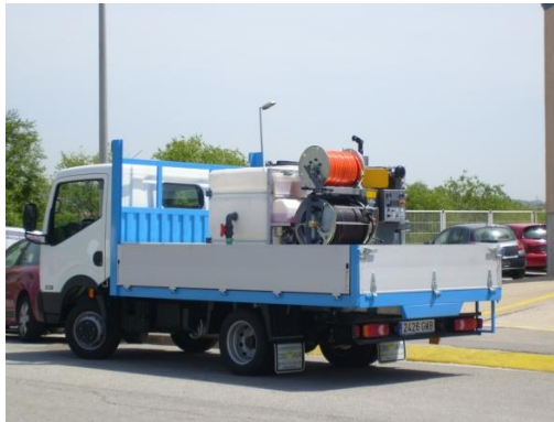
Equipo impulsor en camión de 3.500 Kg.
