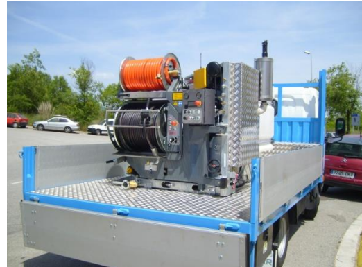
Equipo impulsor en camión de 3.500 Kg.
