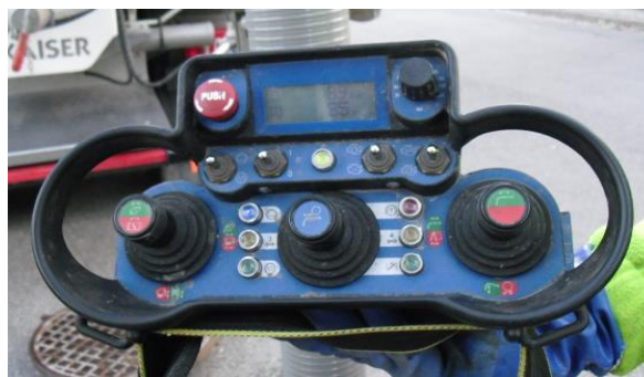
Ejemplo de mando con radio control
